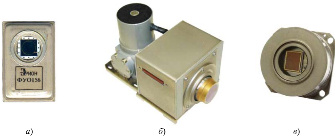
Рис. 2. Фотоприемные устройства различных поколений: а) – ФПУ первого поколения одноэлементное на основе кремния ФУО156; б) – ФПУ второго поколения на основе КРТ формата 4×288 ФЭМ10М – ФПУ третьего поколения на основе InGaAs формата 320×256 с возможностью измерения дальности в каждом пикселе ФЭМ28М; в) – ФПУ третьего поколения на основе InGaAs формата 320×256 с возможностью измерения дальности в каждом пикселе ФЭМ28М
