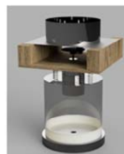
Рис. 1. Фотографии и схема установки, для обработки зерна. Обозначения схемы: 1 – источник питания; 2 – электрический моторчик, создающий вибрации; 3 – кювета; 4 – многоэлектродная композиция; 5 – балластное сопротивление; 6 – источник высоковольтного напряжения
